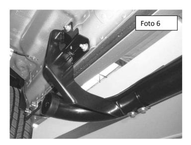
6. Alineé el estribo con la camioneta y apriete tuercas y tornillos. Repita todos los pasos anteriores para la instalación del estribo en el lado conductor.
