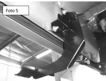
5. Atornille el estribo del pasajero a cada bracket utilizando (2) tornillos 3/8 x 1 ¼", (2) rondanas planas 3/8" y (2) rondanas de presión 3/8". No apriete aún. **(Foto 6)**
